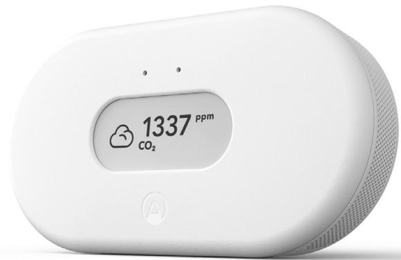
Mit dem Space CO<sub>2</sub> überwachen Sie die CO<sub>2</sub>-Konzentration in jedem Gebäude, überall. Space CO<sub>2</sub> verfügt über ein anpassbares Display mit extrem niedrigem Batterieverbrauch. Es kann nahtlos in eine bestehende Airthings for Business-Lösung integriert werden.
